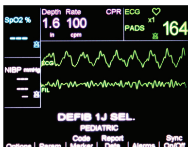
Рис. 2. Отображение на дисплее кривых фильтрованного и нефильтрованного сигнала (технология See-Thru CPR).
